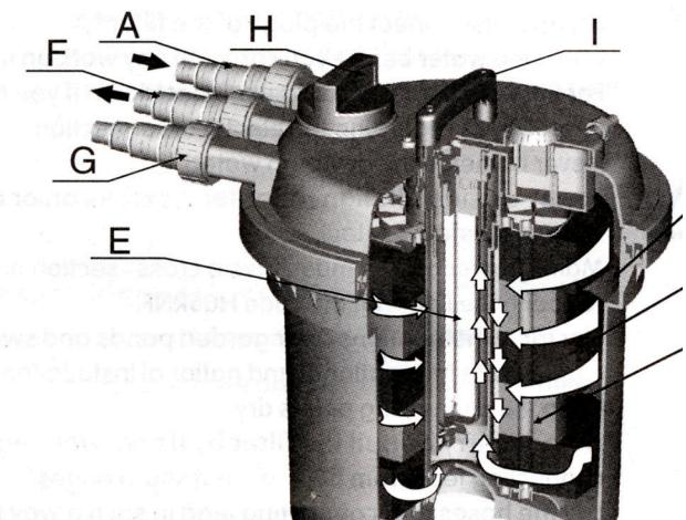
sar bakterier i en anaerobic (syrefattig) miljö som reducerar nitrat till kväve
